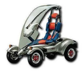
Das futuristische Design und die Grundarchitektur mit hydraulisch kontrollierter, horizontaler Lenkstange und das moderne Chassis machen den P 104 zu einem einmaligen Fahrzeug in bezug auf eine vielfältige Verwendung, Nützlichkeit und Spass. Zudem ist der P104 mit einem 50 cc Benzinmotor, einer automatischen Übersetzung und einem Rückwärtsgang ausgerüstet. Dies alles garantiert einen kostengünstigen Unterhalt und problemloses Fahren.
